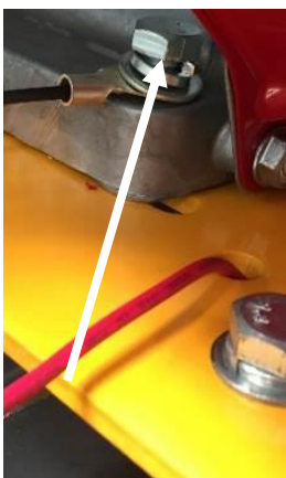
3 CONECTE O ATERRAMENTO AO PARAFUSO DO MOTOR
