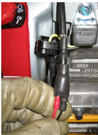
2 CONECTAR EL CABLE ROJO CON LOS CABLES DEL MOTOR
