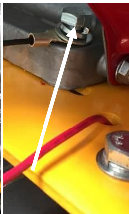
3 CONECTAR LA TOMA TIERRA AL TORNILLO DEL MOTOR
